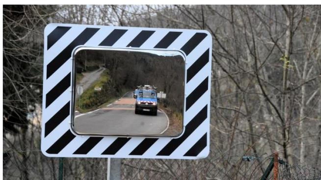
**Sécurisation du carrefour de Lapras :** Le carrefour de la route des Meules à l'entrée de Lapras a été sécurisé par le changement du miroir permettant de s'assurer de la circulation venant de Lamastre. Ce miroir anti-reflet et anti-tuée permet une très bonne visibilité sur ce point critique.
